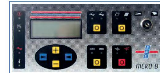
Controllo di saldatura mod. Micro8 Rulli, sincrono a microprocessore a 5 tempi. Provvede alla temporizzazione, sincrona con la frequenza di rete, delle varie fasi del ciclo (accostaggio, saldatura, tempo freddo e mantenimento), ed alla regolazione della corrente di saldatura mediante parzializzazione con scelta della puntatura in modo continuo o in modo impulsivo. Offre di serie il doppio programma.
