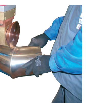
La puntatrice a rullo serie SDPR T-50 è utilizzabile per la saldatura dei condotti d'aria in acciaio inox con spessori da 6/10 - 8/10
